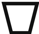
tipologia di crimpaggio per puntalini
