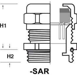
Materiale: pressacavo in ottone nichelato, griffe in policarbonato, O-Ring in Nitrile 70 Sh A, -OTR in tefabloc 80 Sh A, -CPR in gomma 55 Sh A, -SAR in tefabloc 80 Sh A. Guarnizione: -OTR (otturata con griffe), -CPR (a "cipolla" con griffe), -SAR (sagomata con griffe).
